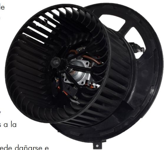
Dado que el ventilador interior funciona a menudo en condiciones severas, sin duda debe soportar saltos de temperatura y períodos prolongados de funcionamiento, a menudo a la velocidad máxima, con el filtro obstruido. El hábito de retirar el filtro de la cabina para aumentar el flujo de aire hacia el automóvil también está bastante extendido. Sin embargo, esto conduce a la obstrucción de los transportadores y a daños colaterales, incluido el bloqueo del ventilador.
