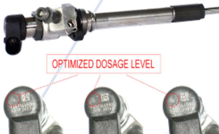
Los números rodeados en rojo indican el grado máximo de dosificación de combustible. Unos valores diferentes pueden causar descompensaciones e irregularidades en el funcionamiento del motor y en la gestión de los gases de escape.
