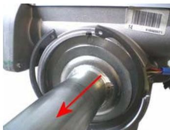
4) Alinee con cuidado las marcas de referencia girando el husillo según sea necesario. Retire el sensor actuando sobre la parte inferior con un destornillador o herramienta similar.
