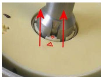
5) Preste mucha atención al nuevo sensor: el clip de retención debe estar perfectamente perpendicular a la estructura de plástico de modo que ambos "discos" del sensor se integren.
