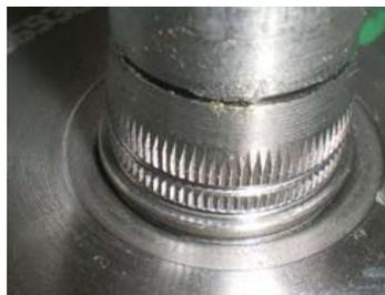
7) Compruebe que los tres puntos de referencia coinciden perfectamente antes del montaje.
